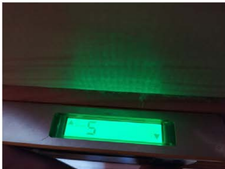
Фото 19. Отклонение венца из бруса от горизонтали на 1м.
