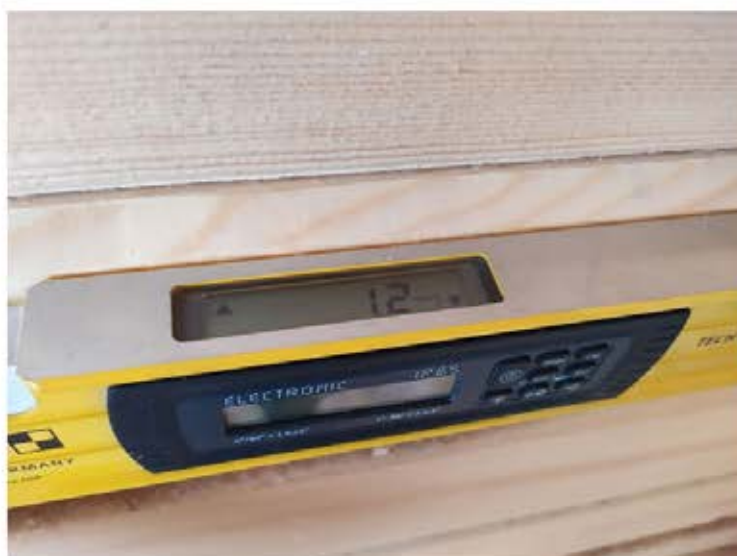
Фото 11. Отклонение венца из бруса от горизонтали на 1м.
